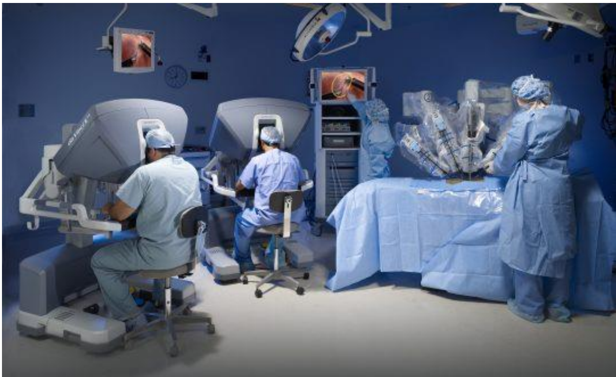
Слика 1 - Да Винчи асистент хирушким захватима (1)
