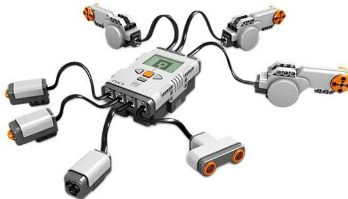
Слика 8 - Lego NXT мотори и контролер (6)
