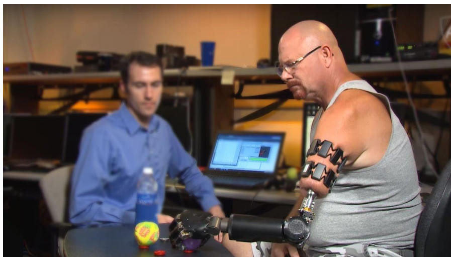
Слика 1.1 Систем за управљање вештачком руком помоћу сигнала добијених са две Myo нарукнице. Слика преузета са [7].
