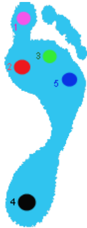
Slika 6.1. Raspored senzora sile (pogled odozgo).
