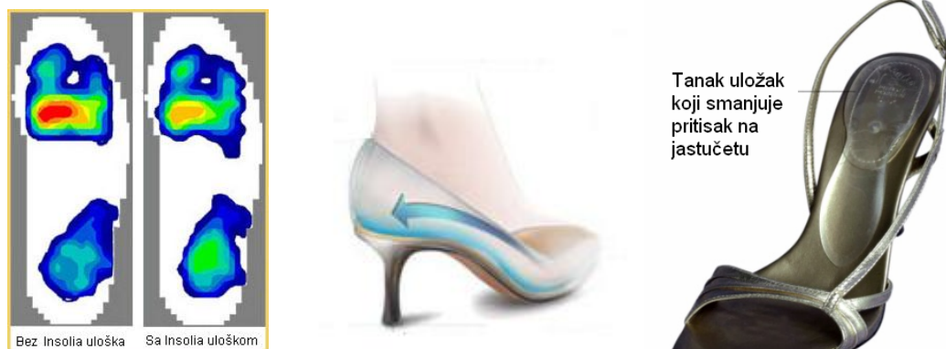
Slika 1.1. Raspored pritiska na stopalo sa i bez korišćenja Insolia uloška, princip „rada“ uloška, i izgled cipele sa Insolia uloškom.
