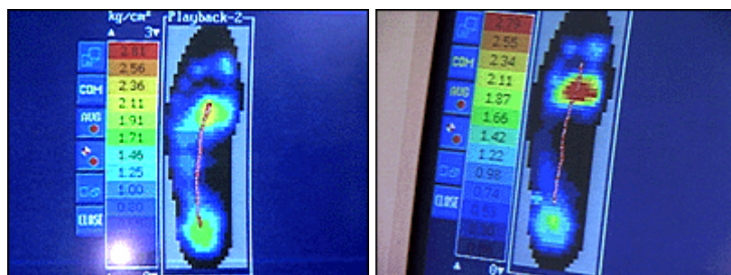
Slika 1.6. Raspodela sile pritiska u patikama (levo) i cipelama sa visokim štiklama (desno). Plava boja odgovara malom pritisku, a crvena boja velikom pritisku.
