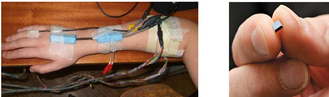
Slika 2.2. Postavka goniometara za merenje uglova u ručnom zglobu i domalom prstu (levo) i prikaz dimenzija inercijalnih MEMS senzora (desno).
