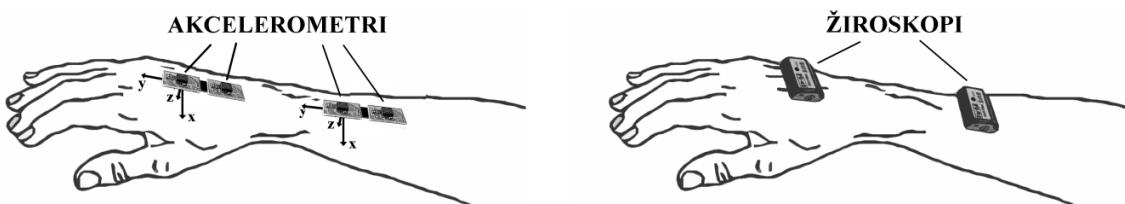
Slika 2.3. Prikaz postavke akcelerometara i žiroskopa za merenje ugla u ručnom zglobu.
