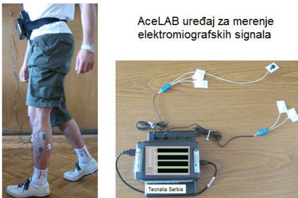
Slika 4, Levi panel: zdrav ispitanik hoda sa AceLAB uređajem (Tecnalia Serbia DOO, Beograd, Srbija); desni panel: uređaj povezan sa računarom i sa dva predpojačavača.
