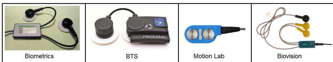
Slika 54, Pregled postojećih komercijalnih predpojačavača koji se koriste za merenje EMG signala: Biometrics (SX230FW EMG, Biometrics Ltd., Newport, UK), BTS (BTS FREEEMG 300, BTS Bioengineering Corp., Forlanini, Italia), Motion Lab (Z03 EMG, Motion Lab Systems, Inc., Baton Rouge, LA, USA) i Biovision (EMG-Amplifier, Biovision, Wehrheim, Germany).
