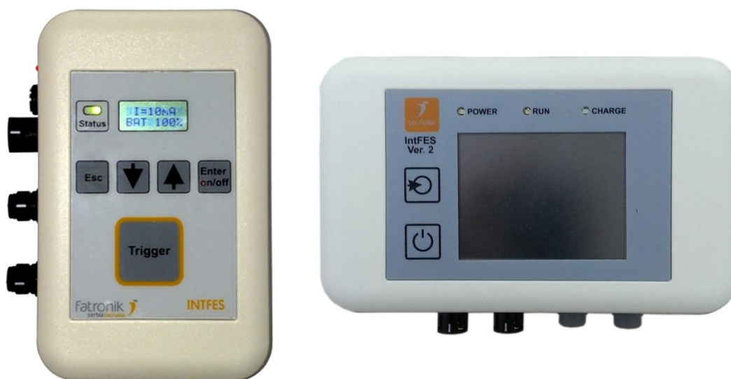
Слика 3.3. Стимулатори ИНТФЕС верзије 1 (лево) и верзије 2 (десно) (Tecsalia Research & Innovation).
