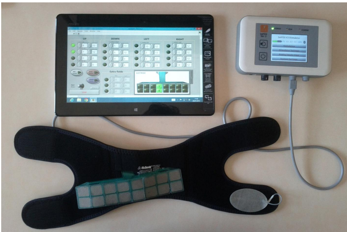
Слика 6.3. Клинички прототип ИНТФЕС система за корекцију падајућег стопала (Tecnalia Research & Innovation).
