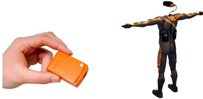
Slika 4. MVN sistem (XSens) za praćenje kretanja sa 17 MTx senzora.. Preuzeto sa http://www.xsens.com/products/xsens-mvn/
