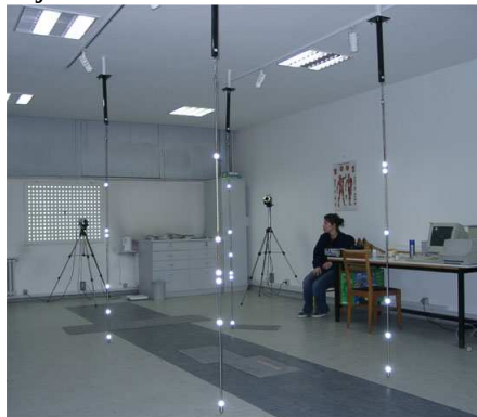
Slika 2. Sistem sa kamerama koje procenjuju položaj markera u prostoru. Preuzeto sa http://biomechanics.me.metu.edu.tr/Motion_Analysis/
