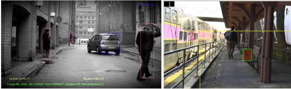
Slika 3: Volvo-ov model S60, pomoću kamere i senzora rastojanja detektuje sve učesnike u saobraćaju (levo). Detekcija napuštenog objekta u regionu od interesa, na jednoj od sigurnosnih kamera (desno).
