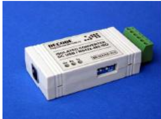
Слика 5: USB/RS-485 комуникациони конвертор
