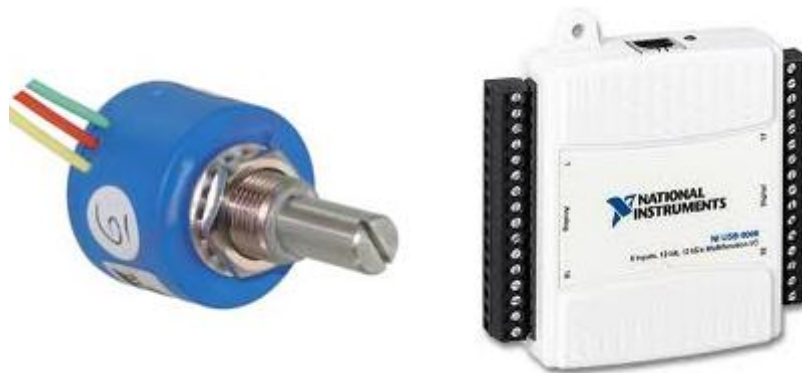
Слика 4: Сензор положаја и аквизициона картица
