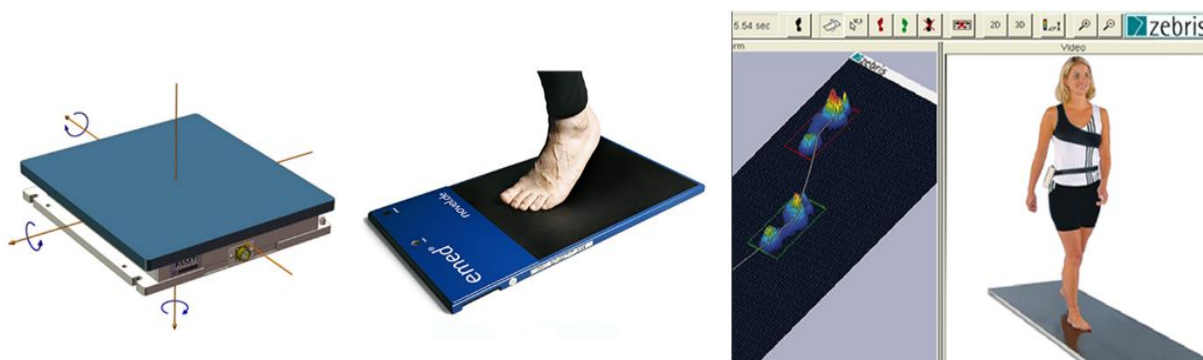
Slika 3.1: Različiti sistemi platformi za merenje sile reakcije podloge. Levo je data platforma koja može da meri tri ortogonalne sile i tri momenta sila [10]. Platforme sa slika u sredini [11] i desno [12] omogućavaju dobijanje prostorne raspodele sila.
