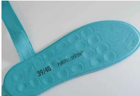
Slika 3.17: Parotec sistem za merenje raspodele GRF-a. Sistem se sastoji od 24 piezoresistivnih senzora.
