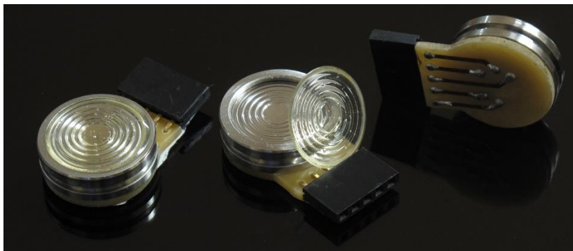
Slika 4.2: MEMS piezoresistivni senzor pritiska ugrađen na štampanu pločicu. Membrana senzora je zaštićena od fizičkog oštećenja postavljanjem sloja epoksidne smole. Ispod senzora je montirana štampana pločica na kojoj se nalazi konektor za povezivanje senzora.
