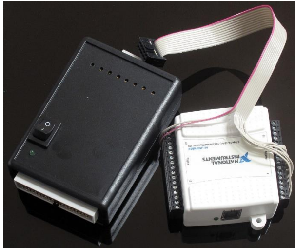
Slika 4.5: Pojačavačka kutija (levo) i AD kartica (desno).
